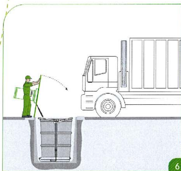
6 El tiempo estimado de vaciado oscila de los 2 a los 2'30 minutos.
