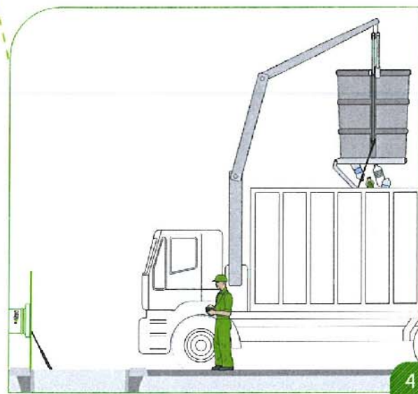
4 El contenedor se vacía por el sistema universal de doble gancho. Los lixiviados de la tapa-depósito se vierten con los residuos en el camión.
